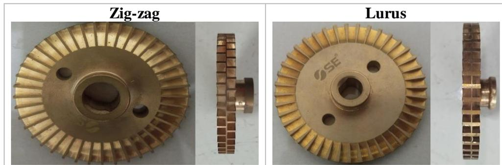
**Gambar 3. 2** Impeller bentuk zig-zag dan lurus
