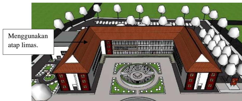
**Gambar 5.7** Penerapan Atap Limas Pada Gedung
