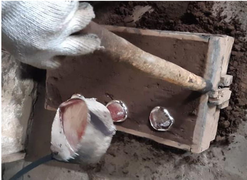
Gambar 2. Penuangan Alumunium Cair Melalui Cawa
