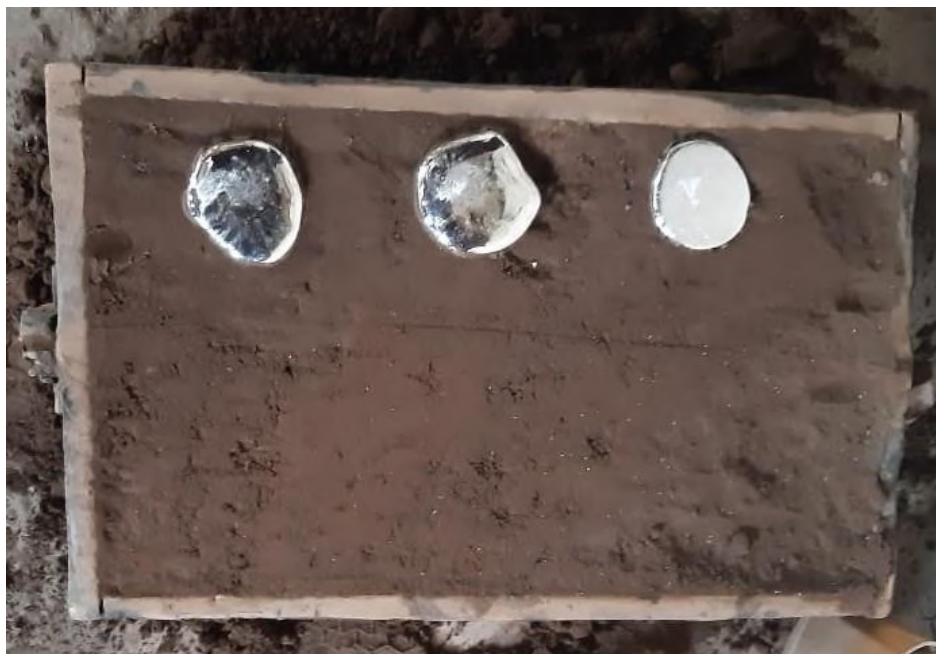
Gambar 3. Menunggu Hasil Pembekuan Alumunium Cair
