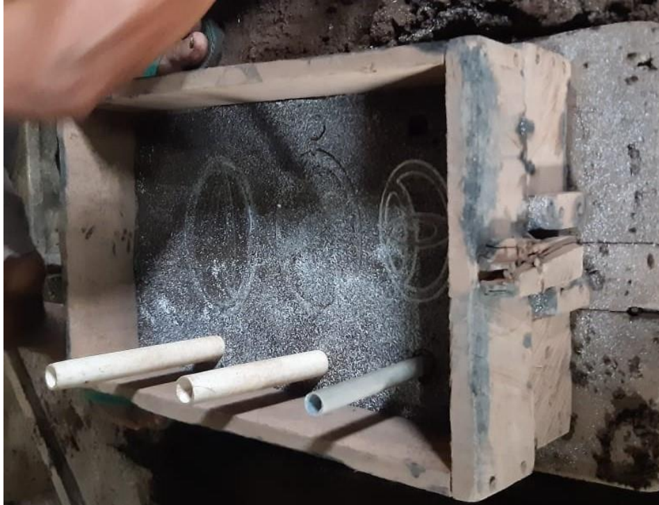
Gambar 1. Proses pengisian pasir pada mall bawah
