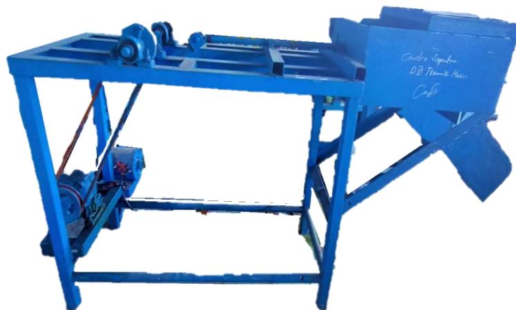
**Gambar 1.1. Alat Press Kaleng Tranmisi Sabuk yang di Modifikasi**
